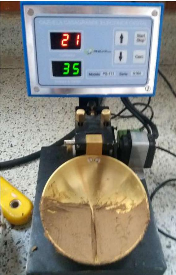
Figura 4. Ensayos de laboratorio (límites de Atterberg).
