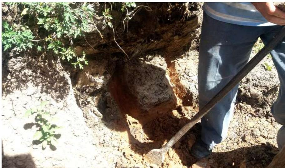
Figura 2. Obtención de la muestra de suelo.
