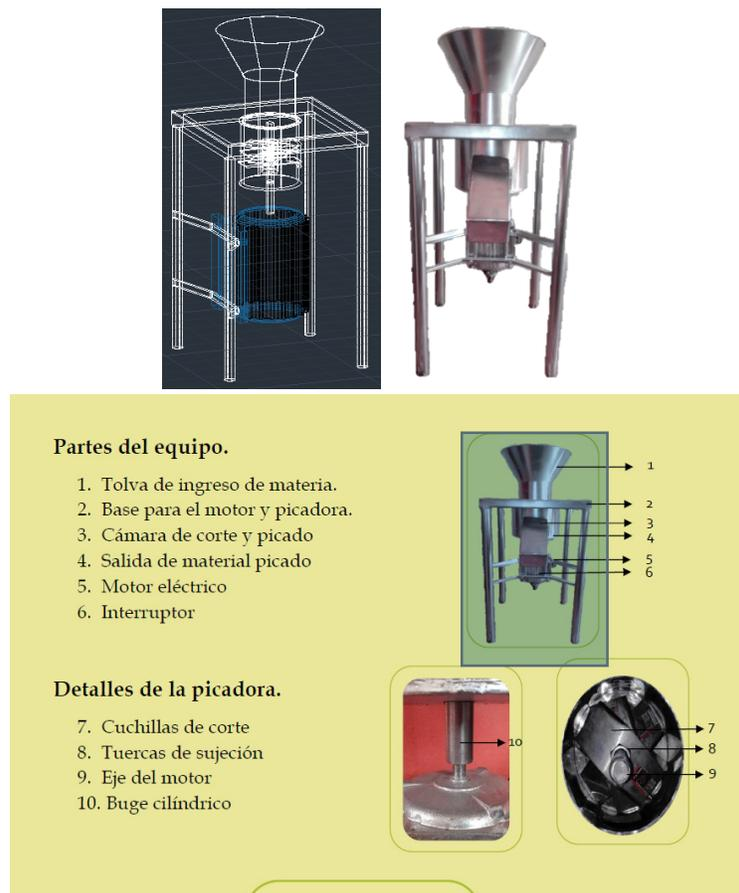
Figura 3. Partes del equipo.
