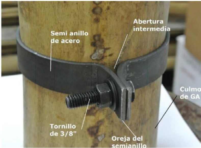
Figura 1. Semi-anillo de acero ajustado a un culmo de GA.
