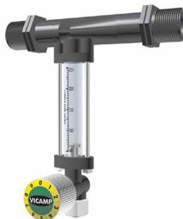
La Figura 4 presenta un medidor de caudal que hace uso del efecto Venturi, fenómeno físico que consiste en que, durante el movimiento de un fluido a través de un conducto, este, al experimentar una reducción de sección, aumenta su velocidad y disminuye su presión, generadas por la diferencia de presiones en su entrada y salida de succión.
