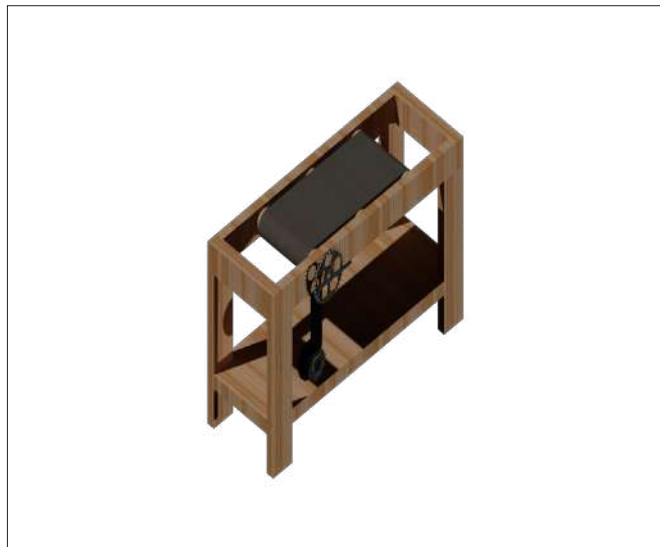
Figura 3. Modelo en 3D de la banda transportadora.
