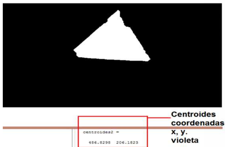
Figura 12. Coordenadas del centroides para figura triangular.
