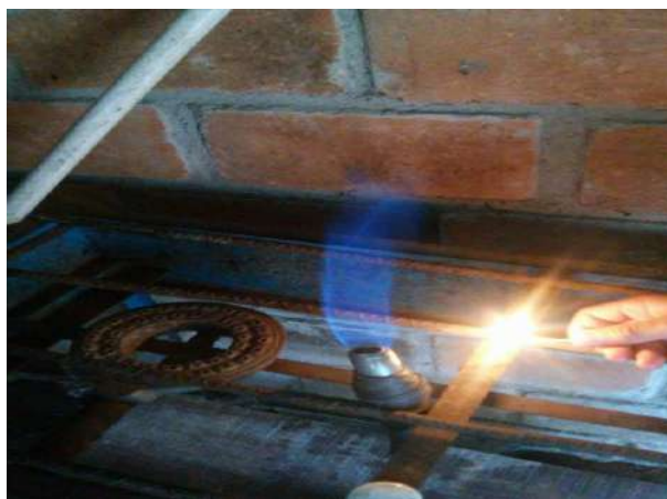
Figura 6. Prueba de llama coloración azul.
