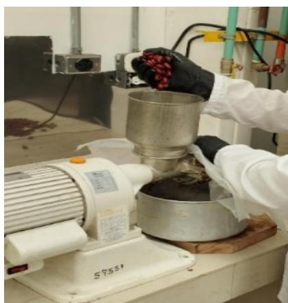
En la reducción del tamaño de los residuos pulpa y mucílago de café se usó dos molinos eléctricos: uno de ellos es una licuadora y el otro, un molino industrial, buscando reducir al máximo el tamaño del residuo, ya que en los procedimientos de hidrólisis es más sencilla su manipulación; además, el pretratamiento por hidrólisis térmica, ácida y enzimática tiene mayor eficacia.
