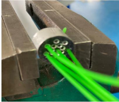
Cuando se obtiene el número de cables, es necesario trenzarlos para formar un torón; este estaría listo para analizar el comportamiento a tracción del nailon trenzado en torones. Una vez configurados los torones de nailon, los sometemos a ensayo de tracción adaptado a la norma NTC 2289 en la máquina para determinar su límite de fallo.
