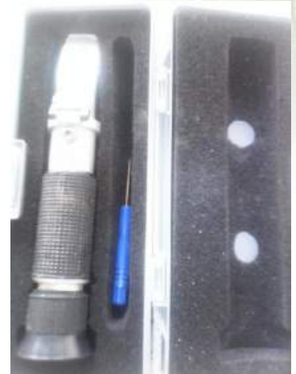
Figura 9. Determinación de sólidos solubles. Refractómetro portátil escala 0 a 32.
