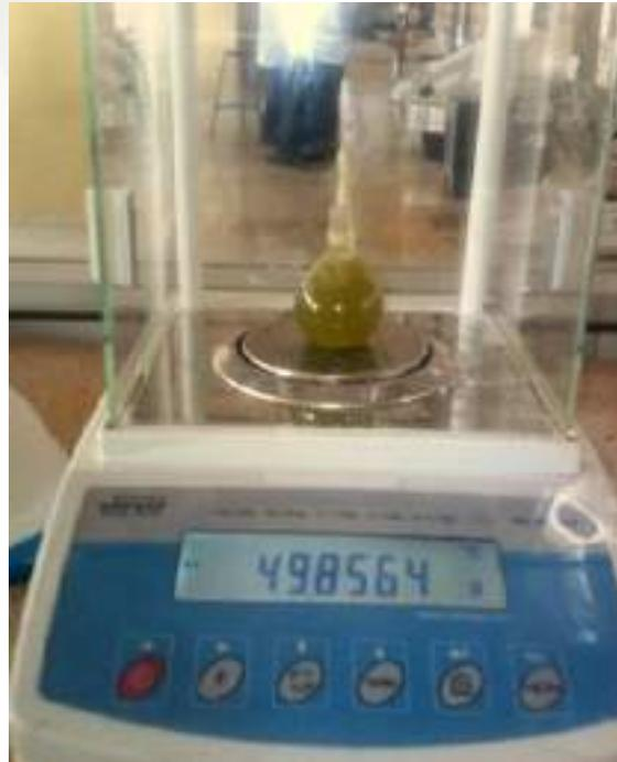
Figura 6. Determinación de densidad relativa prueba de picnómetro.
