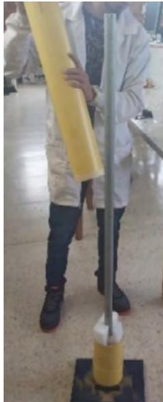
Teniendo establecido todo lo mencionado con anterioridad, se empieza la construcción del aerogenerador con la unión de las partes a la respectiva base, que se une con una cinta adhesiva plateada, la cual brinda un movimiento libre y da soporte adicional en la parte donde se ejerce más deflexión por la fuerza del viento (ver Figura 15).
