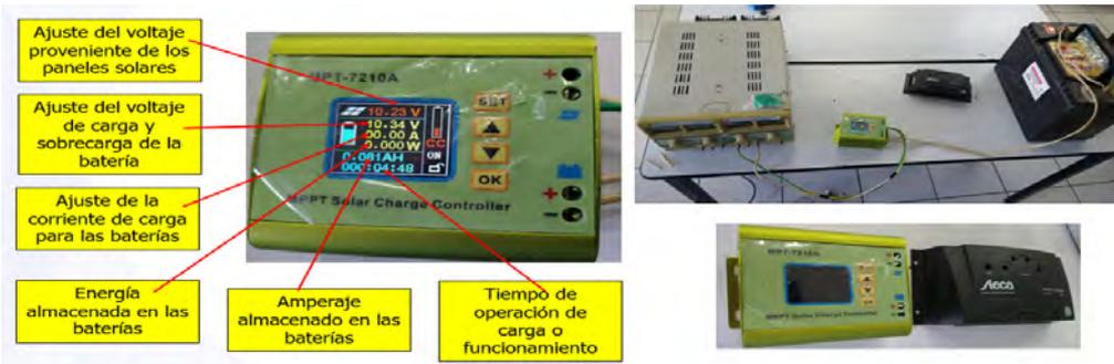
Como segunda etapa, se realiza la conexión del sistema fotovoltaico con el controlador eléctrico del motor que está acoplado con el diferencial para evaluar su funcionamiento. Cabe mencionar que, el estudio se encuentra en el proceso del diseño del chasis para el minitractor, en el cual se realizará el montaje del sistema fotovoltaico, controladores, baterías, motor con diferencial y accesorios (ver Figura 14).
