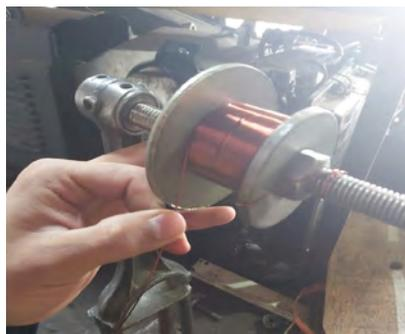
Para su elaboración, se tuvo en cuenta el calibre y el número de vueltas previamente calculado. En este caso, se utilizó un calibre 30, se realizó un aproximado de 14.000 vueltas; después de realizar la bobina, se procede a sellar con resina epoxi aislante sin solventes para inducidos y bobinados; esto ayuda a que el embobinado no se raspe o ingrese agua, ya que puede producir un corto.
