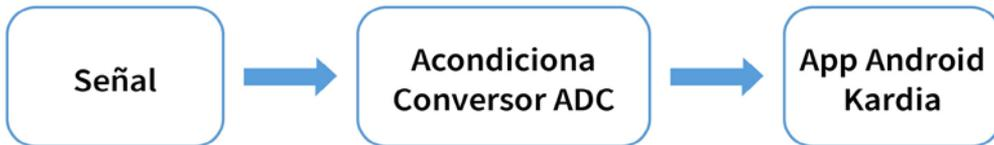
El firmware captura la señal cardiaca proveniente de los electrodos, para luego ser procesada en el conversor ADC, el cual convierte la señal análoga a digital para ser enviada por medio de Bluetooth al móvil Android. El microcontrolador MSP430G2553 permite la recepción y emisión de datos a través del puerto serie del microcontrolador.
