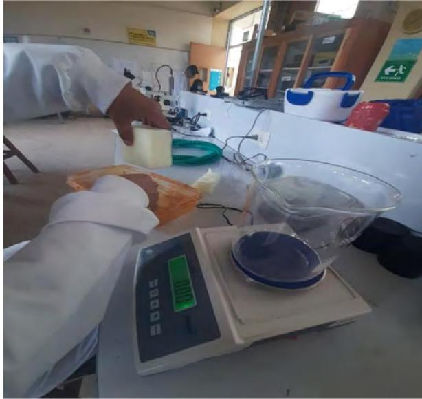
Haciendo una relación entre las partes de la espuma y el agua absorbida, se puede determinar que, por cada gramo de espuma, se almacenó aproximadamente 32 g de agua; por lo tanto, también se puede hacer una relación con una alta porosidad de la espuma.
