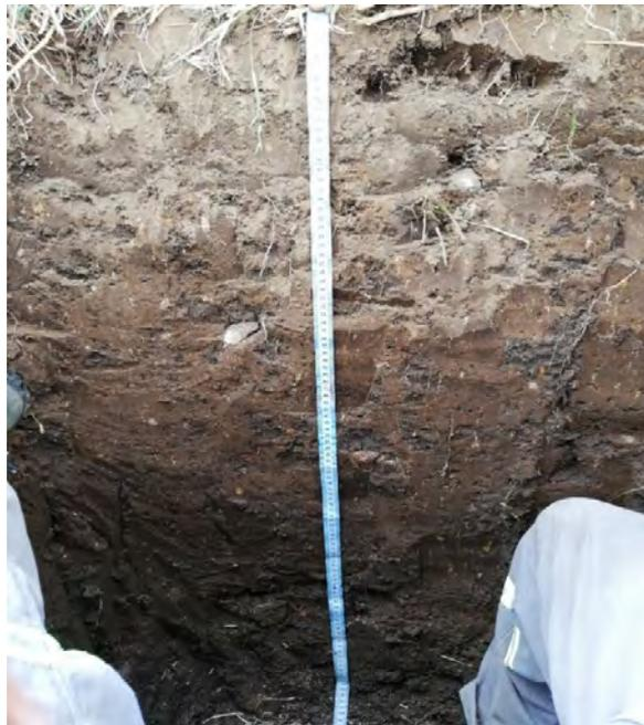
De suerte que sea posible evidenciar los horizontes de la misma y realizar extracción de muestras; se evidencia los resultados en la Tabla 3:
