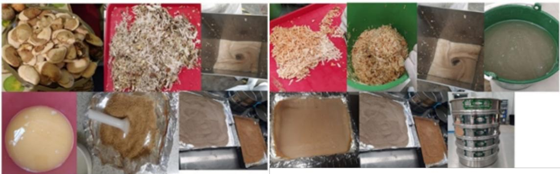
*Nota.* De izquierda a derecha: proceso de rallado de semilla de aguacate, pretratamiento con ácido acético, proceso de trituración en licuadora de tipo industrial, precipitación de la mezcla, secado y disminución de tamaño y tamizado. Endocarpio, rallado de semilla de mango, proceso de triturado en licuadora industrial, precipitación del almidón, disminución de tamaño, almidón seco.
