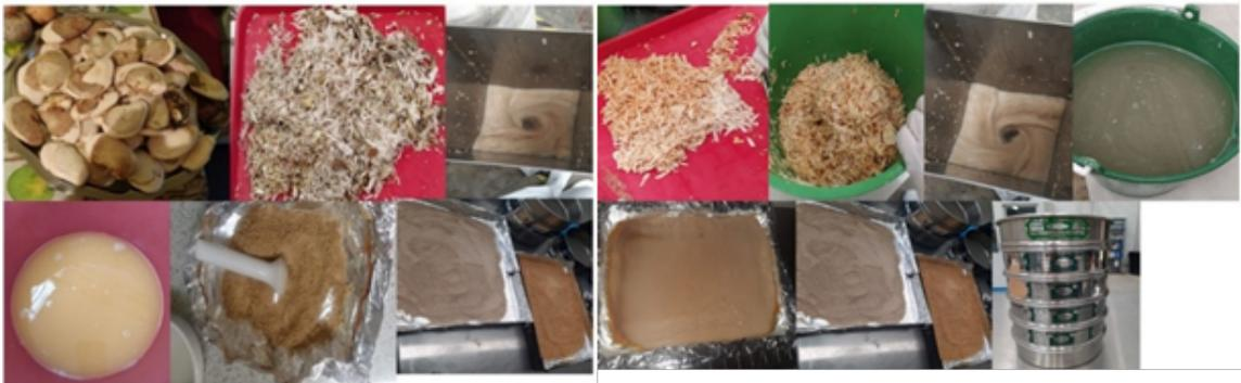
*Nota.* De izquierda a derecha: proceso de rallado de semilla de aguacate, pretratamiento con ácido acético, proceso de trituración en licuadora de tipo industrial, precipitación de la mezcla, secado y disminución de tamaño y tamizado. Endocarpio, rallado de semilla de mango, proceso de triturado en licuadora industrial, precipitación del almidón, disminución de tamaño, almidón seco.
