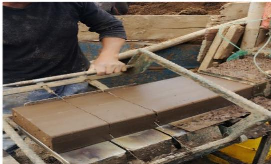
La Figura 7 muestra que la máquina moldeadora utilizada tiene la capacidad de extraer bloques del material para, posteriormente, ser cortado en las medidas específicas.
