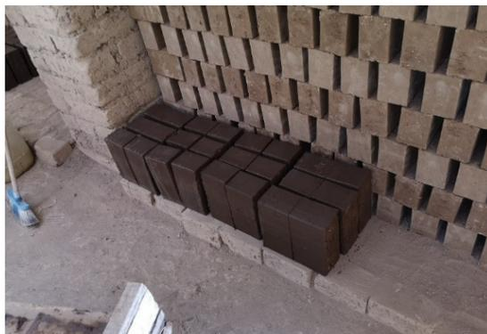
Como se observa en la Figura 8, el secado es, quizás, el paso más largo en la elaboración del ladrillo, ya que se requiere mínimo, 15 días para continuar con el quemado.
