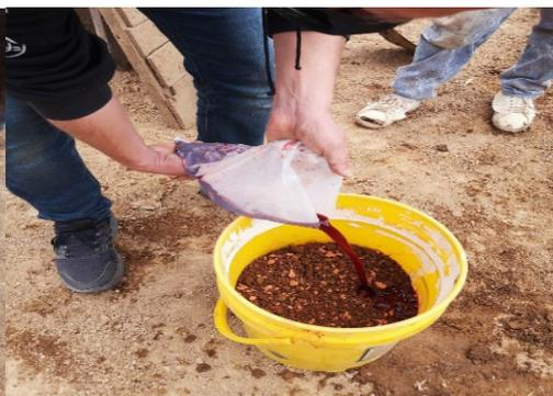
Con las Figuras 5 y 6 se puede apreciar que, durante el mezclado se reemplaza un porcentaje de arcilla por escombros y se lo humedece con 0,35 litros de sangre bovina por unidad.
