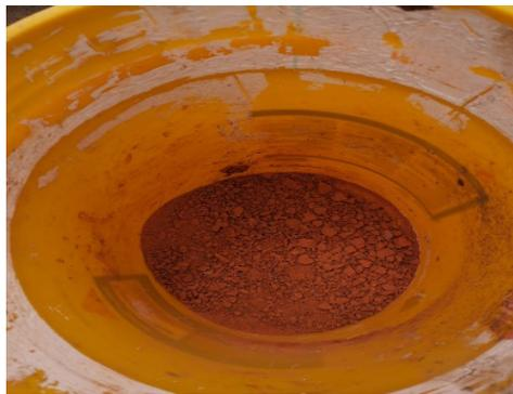
La Figura 4 explica que, una vez culminado el proceso de selección del material a reutilizar, se procede al triturado en una máquina, dejando el material en granos no superiores a dos milímetros.
