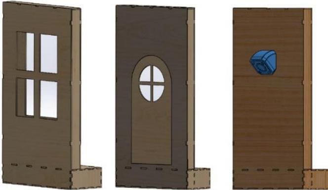
El sistema domótico está compuesto por una puerta que cuenta con un servomotor, el cual por medio de un mecanismo biela-manivela puede abrir y cerrar la puerta; también está el módulo de la ventana que funciona por medio de dos servomotores, los cuales mediante una palanca abre y cierra la ventana y, por último, está el módulo de la bombilla, mediante un relé activa la entrada a 110VAC, cada vez que la señal EMG sea detectada y el procesador la clasifique.
