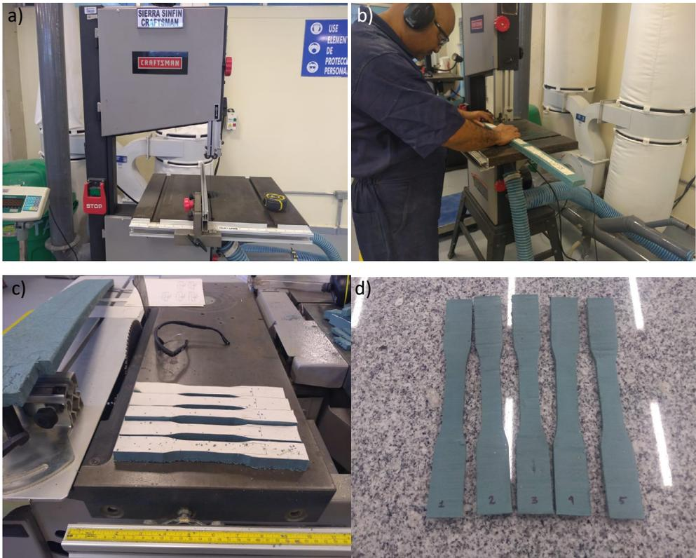
Dentro de la zona de falla de cada muestra se marcaron las respectivas líneas guías (Figura 3a); se midió la distancia entre ellas y el espesor antes y después del ensayo, con la finalidad de conocer la elongación del material e identificar el tipo de falla.
