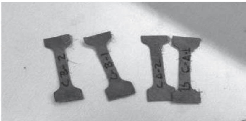
Figura 51. Probetas cortadas para realizar el ensayo de resistencia a tracción (NTC-ISO 3376 de 2002). Muestra 3 Pieza M3 H C-1 Curtido quebracho Modificado, color café. Código muestra: 135-C-2016.
