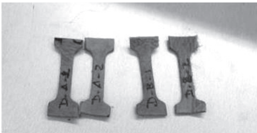
Figura 52. Probetas cortadas para realizar el ensayo de resistencia a tracción (NTC-ISO 3376 de 2002). Muestra 4 Pieza M5 H C-1 Curtido quebracho Modificado, color café. Código muestra: 135-D-2016.
