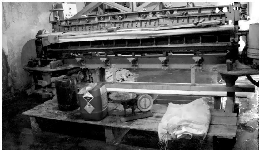
Figura 9. Máquina especializada en separación de la parte interna y externa del cuero.
